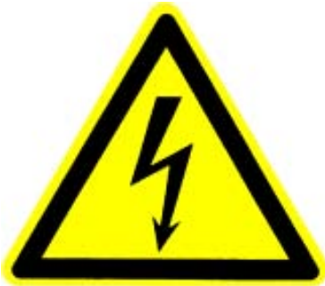
W08 Warnung vor gefährlicher elektrischer Spannung
