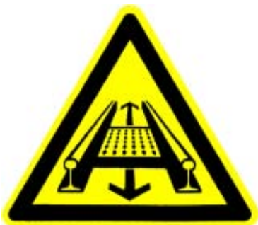
W29 Warnung vor Gefahr durch eine Förderanlage im Gleis
